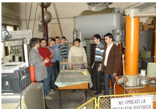
Studiul descărcărilor electrice în câmp uniform slab neuniform, puternic neuniform.
