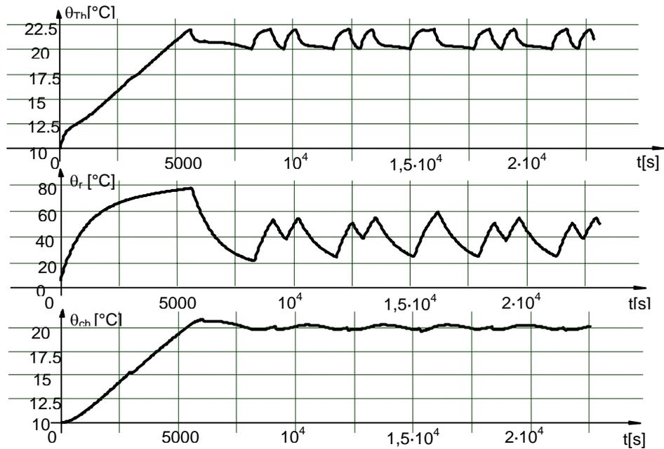
Fig.10 Petri net simulation results for:  $c_1 = 10^{-4} \text{ s}^{-1}$ ;  $c_2 = 5 \cdot 10^{-5} \text{ s}^{-1}$ ;  $c_3 = 5 \cdot 10^{-3} \text{ s}^{-1}$ ;  $c_4 = 10^{-3} \text{ s}^{-1}$ ;  $Q_1 = 0.012 \text{ }^\circ\text{C/s}$ ;  $Q_2 = 0,06 \text{ }^\circ\text{C/s}$ ;  $teta_1 = 20 \text{ }^\circ\text{C}$ ;  $teta_2 = 22 \text{ }^\circ\text{C}$ ,  $\theta_e = 10 \text{ }^\circ\text{C}$ ,  $d_1 = 3000 \text{ s}$ ,  $d_2 = 60 \text{ s}$ ,  $v = 0,005$ .
