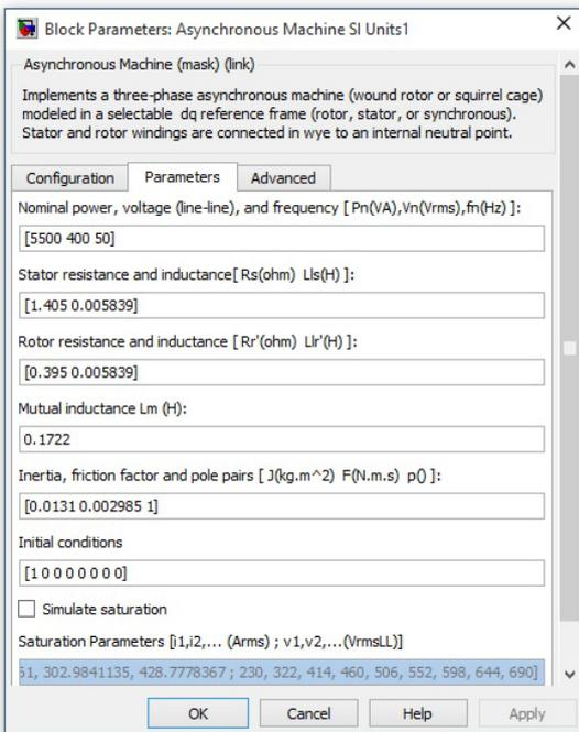
Fig. 4. The asynchronous motor parameters
