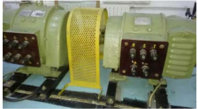
Fig. 12. The active load of the boost PWM rectifier
