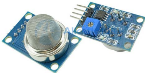
Fig. 5. MQ-135 gas sensor module [13].
